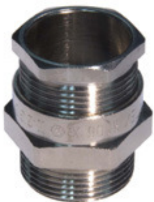
Foto: EExe pakknippel også for EMC beskyttelse. Nippelen har innvendig potensialutjevning/jording av EMC-skjermen ved at en kon blir presset sammen rundt skjermen.
