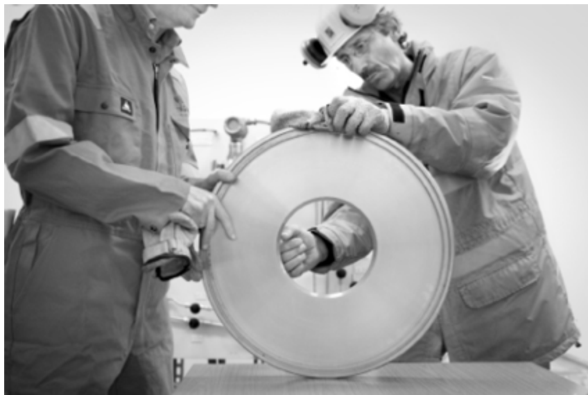
Blendeplaten. Gassen sluses gjennom hullet i en slik stålplate for måling. Målespesialist passer på blendeplatene som om de var gullbarrer.
