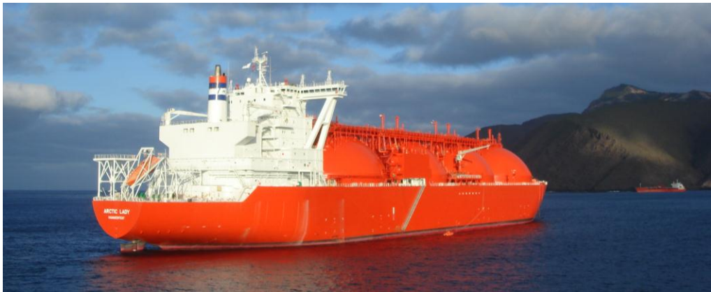
LNG skip med sfæriske tanker, Moss-design (bildebruk etter tillatelse fra Höegh LNG).
