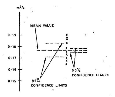
FIG 1. ILLUSTRATING THE LINK BETWEEN UNCERAINTY AND CONFIDENCE LEVEL
