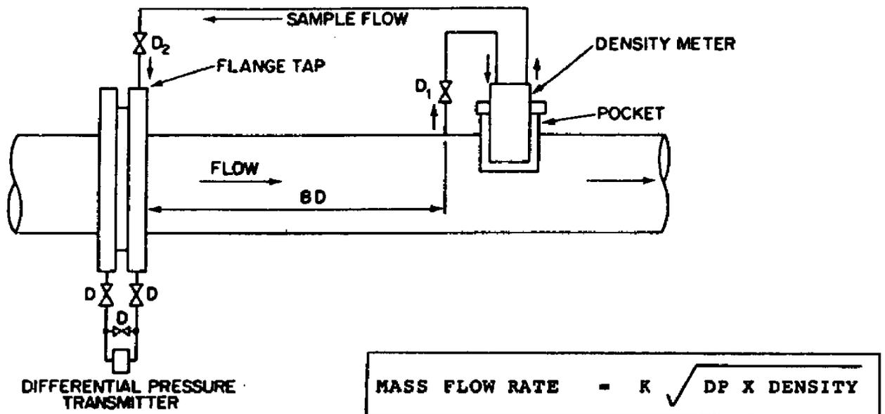
Fig 1 ORIFICE GAS METERING SYSTEM
