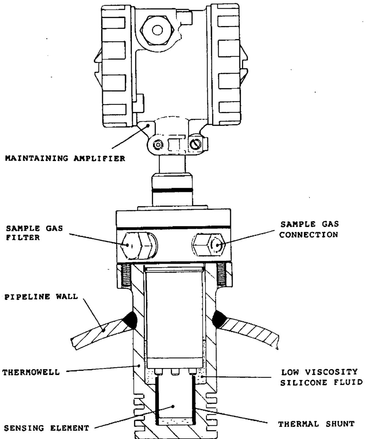
**Fig 2**      **GAS DENSITY TRANSDUCER**      **Type 7812**
