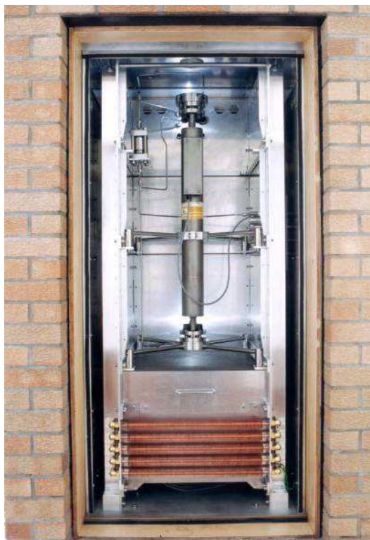
Fig. 7 - NEL Industrial Densitometer Calibration Facility
