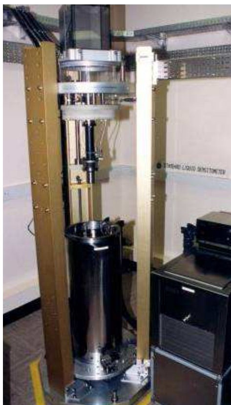
Fig. 5 - NEL Primary Standard Liquid Densitometer
