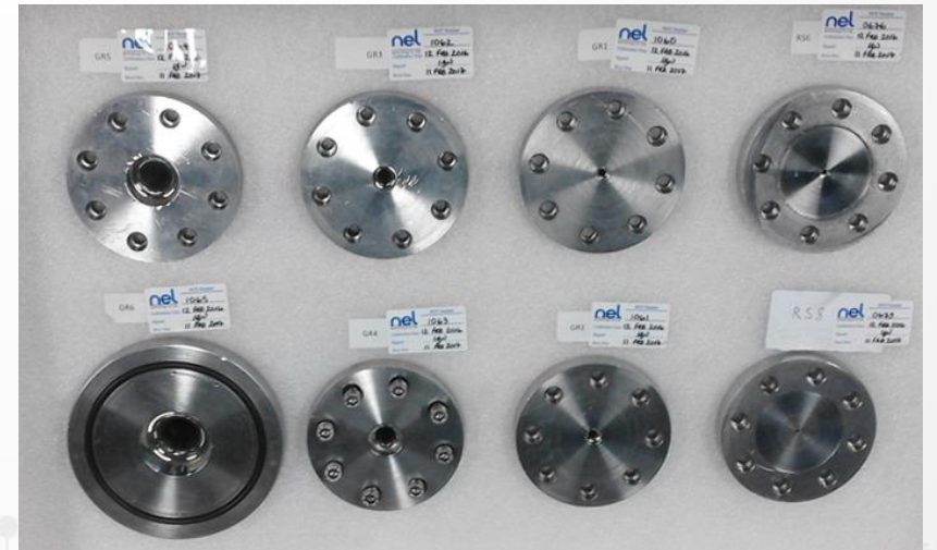
NEL reference nozzles, throat diameters 1.25 to 16 mm
